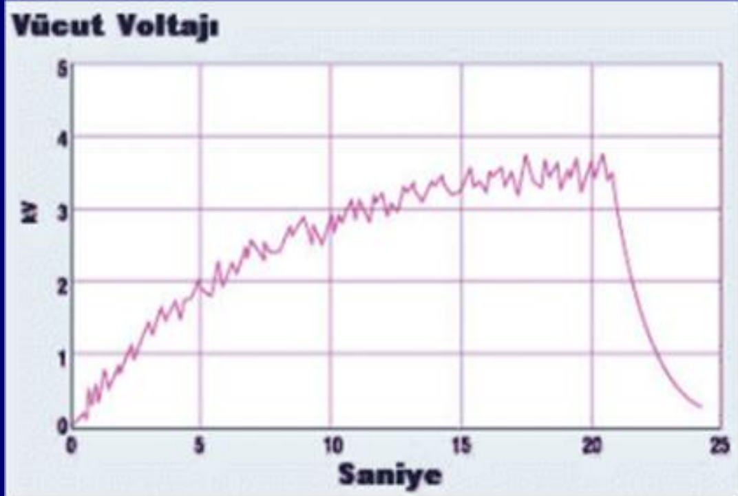
Şekil 1. Ayak ile zemin arası statik yüklenme
